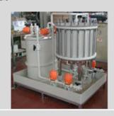
ELETTRODIALISI PER RECUPERO ACIDI E METALLI DA BAGNI DI DECAPAGGIO
